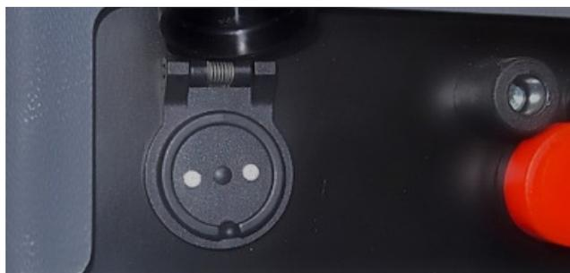
**EASY-PLUG** Ladeadapter - Die Ladeverbindung wird bei Zugbelastung AUTOMATISCH getrennt.
